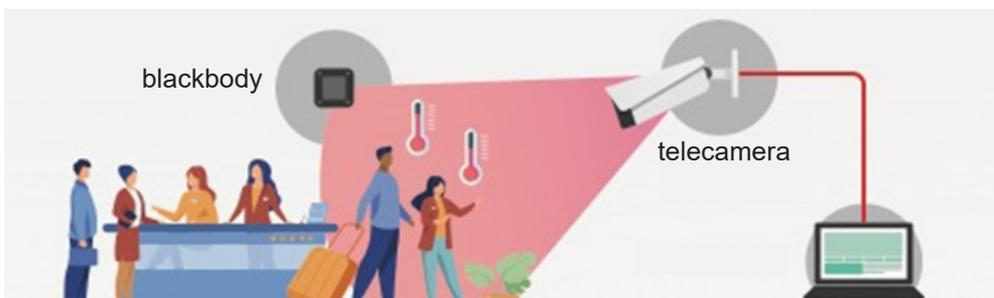
Tramite l'interfaccia web della telecamera è possibile visualizzare in tempo reale la temperatura rilevata e agire di conseguenza, avviando, per esempio, la comunicazione bidirezionale verso il microfono e lo speaker integrati nella telecamera al fine di evidenziare il soggetto. Al superamento della soglia di temperatura è possibile attivare un indicatore luminoso e/o riprodurre un messaggio audio dallo speaker integrato.
